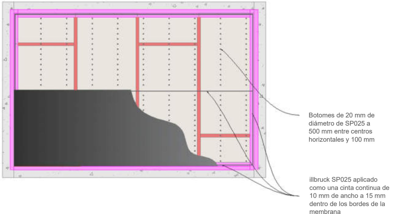
Para cargas de viento de bajas a medias, debe aplicarse un cordón de 10 mm de ancho de adhesivo SP025 alrededor de todo el perímetro de la membrana. Para cargas de viento superiores, la adherencia puede mejorarse aplicando botones de 20 mm de diámetro de adhesivo SP025 a 500 mm entre centros horizontales y 100 mm entre centros verticales.
