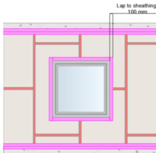
**Método 1 - adecuado para cargas de viento de bajas a moderadas o cuando el soporte de revestimiento se instalará inmediatamente después de la aplicación de la membrana.**
