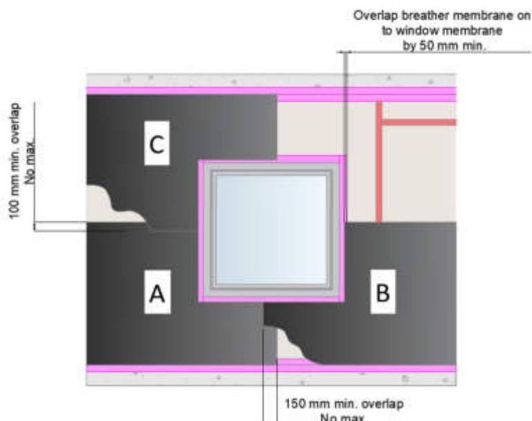
Todos los solapamientos se sellan con la cinta illbruck adecuada, se aplican sin burbujas ni arrugas y la unión se consolida con un rodillo de membrana.
