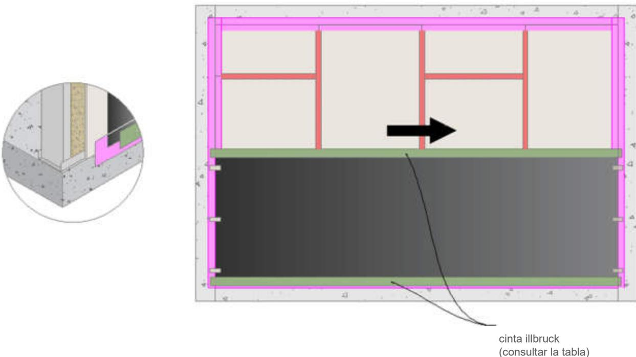
Despliegue la membrana horizontalmente hasta llegar al final del vano o de una abertura, aplicando más tramos de cinta adhesiva a intervalos no inferiores a 450 mm ni superiores a 1.000 mm para fijar temporalmente la membrana en su posición.
