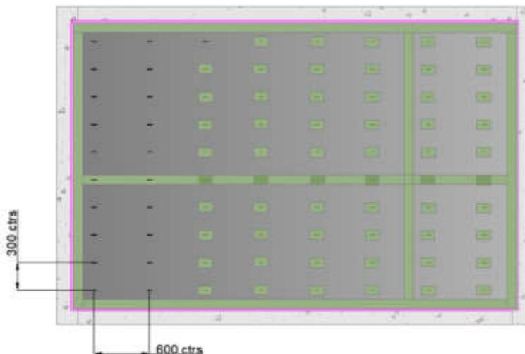
Para otros tableros de revestimiento y sustratos en los que las grapas no son adecuadas o para un método de fijación más robusto, se instalan tornillos de acero inoxidable a través del tablero de revestimiento en el SFS a 500 mm entre centros verticalmente y para alinear con cada montante.
